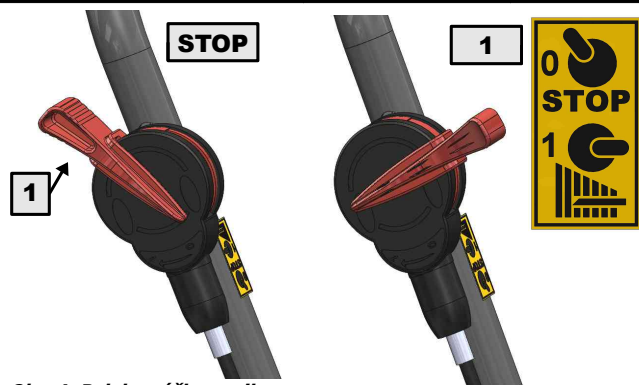
Obr. 4: Polohy páčky spojky žacího disku
